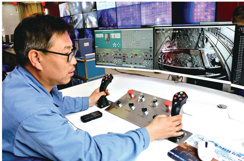
太钢代县矿业公司坚持对标先进,全力打造智慧化地下矿山样板,使操作更智能、安全、便捷。图为操作岗位工正在远程操控无人驾驶电机车。
