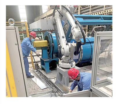
随着中国 宝武"工业大脑" 战略计划全面启 动,山西宝信积 极推进宝武万名 "宝罗"员工上岗 项目实施。目前 已开展的太钢炼 钢一厂、炼钢二 厂、冷轧硅钢厂 不锈冷轧厂等机 器人正在加紧实 施中。图为山西 宝信工程通信事 业部职工在冷轧 硅钢厂进行3号 包装线喷号机器 人的安装调试。
