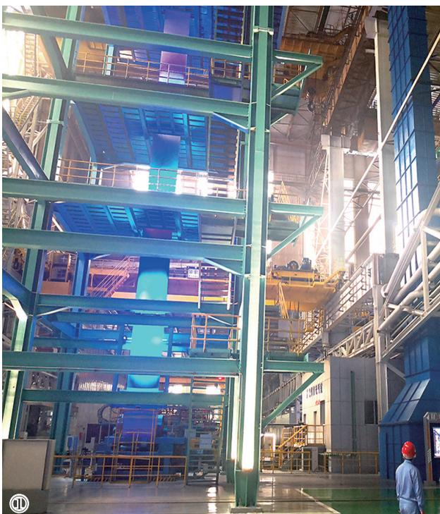
(上接第三版)利用CO<sub>2</sub>对钢渣进行稳定化处理,实现“以碳治渣、以渣固碳”。目前,太钢已开发了“碳酸化蒸养”“碳酸化焖渣”“连续碳酸化”三条技术路径,固碳率可达100kg/t,渣中游离氧化钙降至2%以下。
