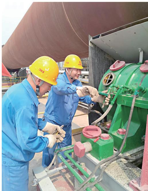
太钢复合材料厂焙烧作业区充分发挥人员效率，解决生产过程中的突发故障问题。图为焙烧作业区轻烧回转窑生产系统技术人员到高纯镁钙砂生产系统进行回转窑托轮渗水处理。
