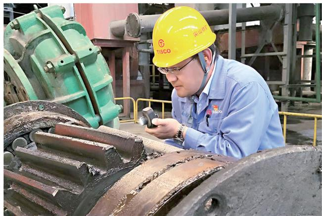
太钢尖山铁矿加强对备件使用过程的全面管控,及时做好数据收集管理工作,最大限度地发挥设备效能,保证生产的稳定运行。图为设备管理人员对齿轮轴进行现场检查分析。 李晓鹏 摄 陈小革 文
