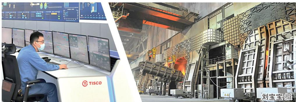
本报讯(通讯员 郝咪咪) 10月27日,太钢炼钢二厂北区转炉成功“一键炼钢”,实现了转炉从装炉结束到出钢的全流程自动控制,彻底打破了传统的炼钢操作模式,完成了炼钢人多年的夙愿,为太钢实现“四个一律”迈出了革命性的一步。该厂自今年8月11日完成“自动出钢”到现在“一键炼钢”成功实现,标志着该厂真正进入智能化炼钢的新时代。
