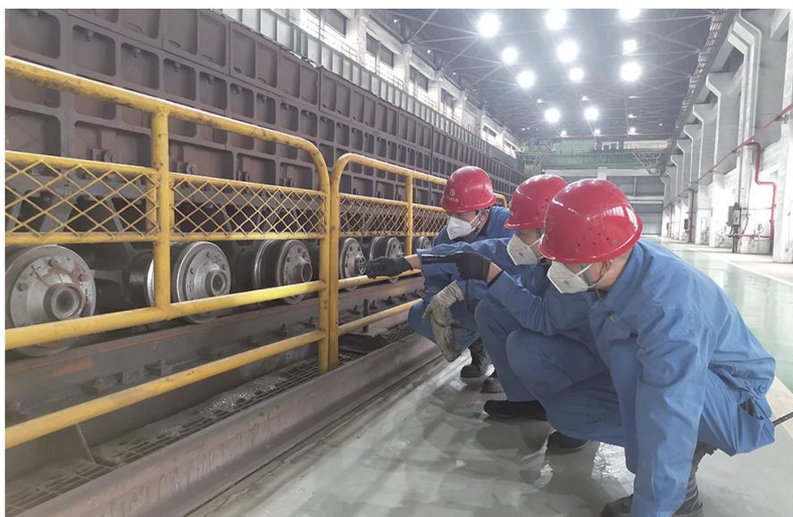
太钢炼铁厂规范设备全过程管理,强化设备管理质量,以精密点检为核心,结合日常巡检、“小神探”点检,提高设备稳定运行水平,以高效率的设备运行行为生产保驾护航。图为设备点检员点检烧结机轨道润滑。 汪洋摄
