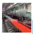
背景:现辊道驱动方式为 单台变频器驱动N根辊道方 式运行,变频器只能检测全部 电机运行的总电流数值,控制 系统无法识别每根辊道的运 行状况和过程"健康"状态,当 某根辊道瞬间发生卡阻堵转、 接手异常脱开、辊道运行过程 劣化等情况,造成带钢表面划 伤等质量事故。
