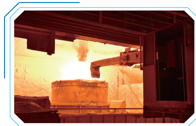
图为自动扒渣作业现场。
