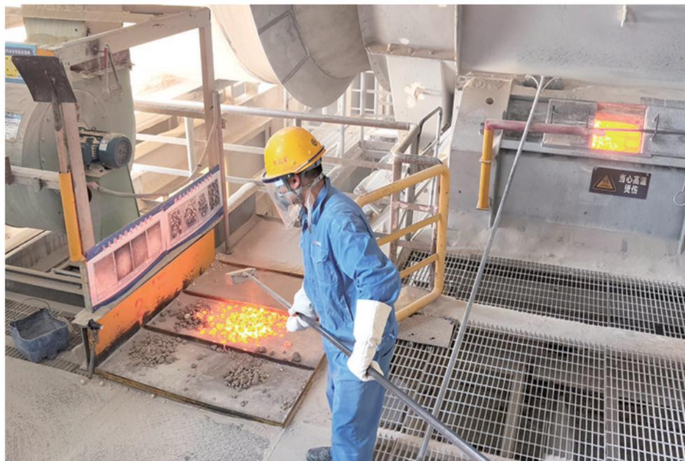
为了更好地满足回转窑工艺需求,太钢东山矿细石灰石理化指标管控和回转窑逐班工艺参数监控反馈,确保石灰质量稳定优质。图为职工进行石灰取样检测作业。
