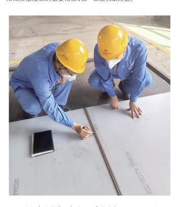
太钢复合材料厂在增强全员质量意识的同时,促使全员质量管理达到新水平。图为质量管理人员认真分析不锈钢复板拼焊质量,确保复合板表面质量的进一步提升。
