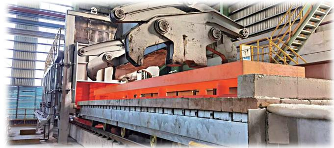
热轧厂1780产线钛板电加热炉项目,自9月25日开始施工,经历了前期土建浇筑、设备安装调试、模拟出钢轧制等环节后,于12月4日15时42分,钛板电加热炉热负荷生产成功,15时48分第一条钛板成卷。
