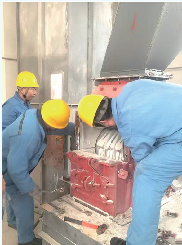
设备完好是安全生产的保障。近日,太钢东山矿制粉事业部对生产线所有设备进行了全面隐患排查。图为岗位人员对破碎机磨损锤头进行更换。 徐丽玲 摄
