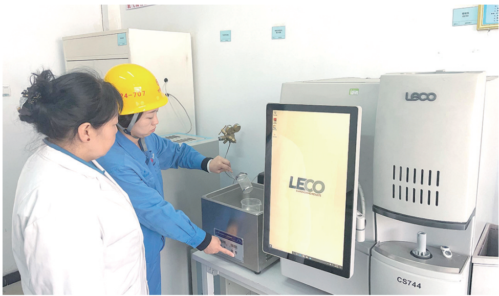
太钢岚县矿业公司计量检验室针对因高频红外碳硫仪长时间使用,易产生灰尘、积垢,影响试样的准确分析等问题,组织专业人员定期清洗滤网,确保设备正常运行。图为使用超声波清洗机清洗滤网。
