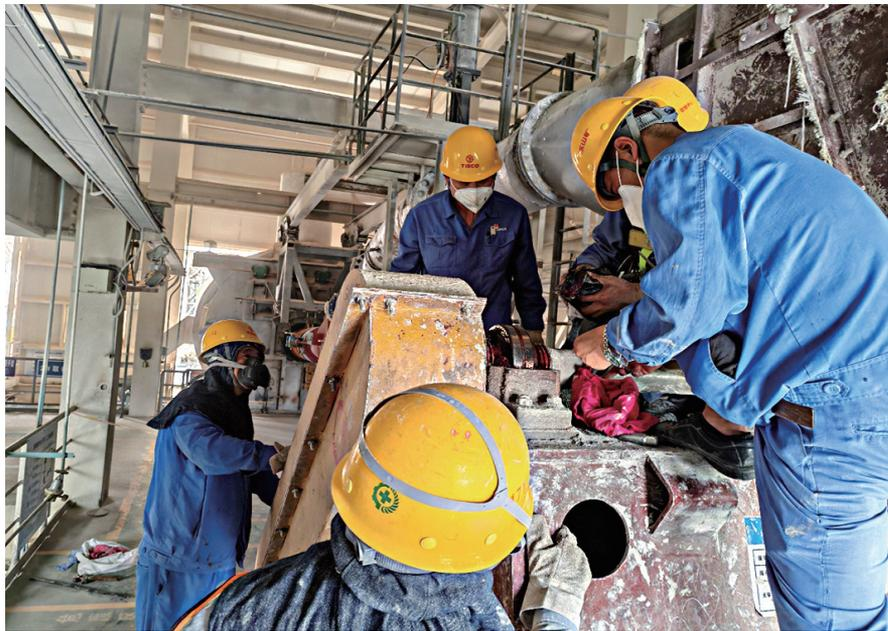
太钢东山矿回转窑作业区加强设备的日常点检和维护,对以往需要年检来完成的大修设备,转化为定检维护,在合理安排定检部位、工序等重要环节后,大大缩短了对年度检修的依赖,提升了生产效率和效益。图为回转窑作业区定检煤排风机轴承。
