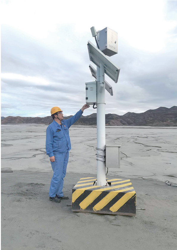
尖山铁矿尾矿库在线监测系统主坝干滩监测仪器处于最高主坝断面之上,长时间大风天气对干滩监测仪器装置作用影响,导致干滩监测数据误差增大。为了实时提高监测数据有效性,自动化室对主坝干滩监测仪器运行参数多次进行优化处理,提高主坝干滩断面的滩顶高程监测数据和干滩长度数据的准确性。图为改善现场。 孙秀丽 摄
